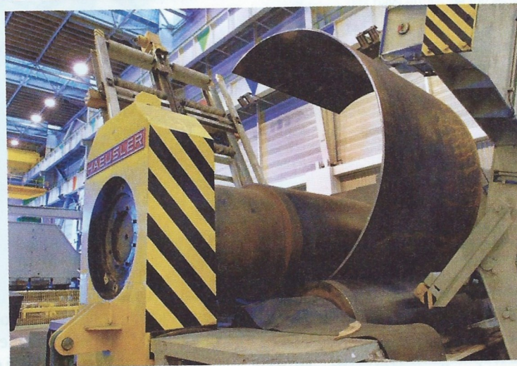
Les rouleuses utilisées par Naval Group permettent de rouler des tôles de forte épaisseur et d'une largeur allant jusqu'à... sept mètres!
