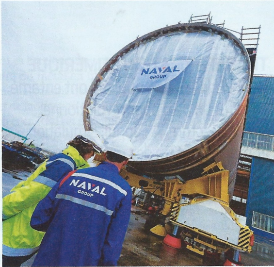
À l'extérieur, un tronçon intègre le hall d'assemblage.
