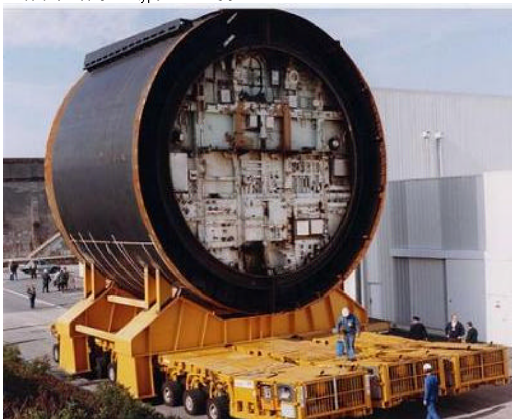
Le tronçon de coque contenant la chaudière du REDOUTABLE est transporté sur son site d'entreposage dans l'arsenal de CHERBOURG en vue de son démantèlement
