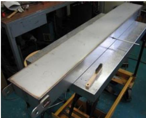
Essais de fabrication par Compression Isostatique à Chaud (DRT/LITEN)
