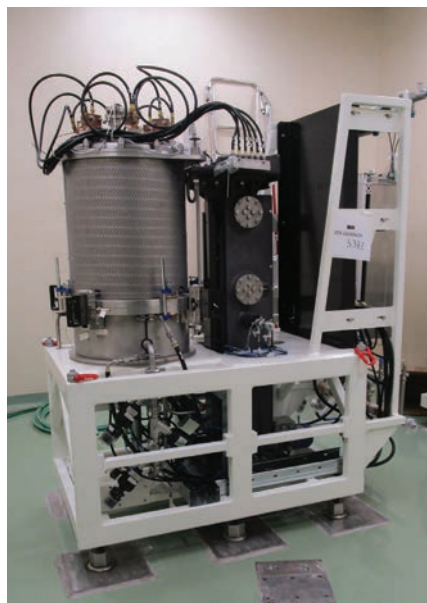
L'un des 4 nouveaux fours de frittage des plaquettes de combustible du bloc O
